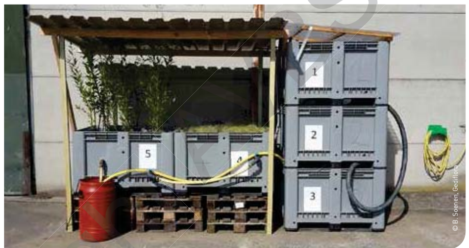
▲ Opstelling van de biofilter van het PCS op een chrysantenbedrijf
