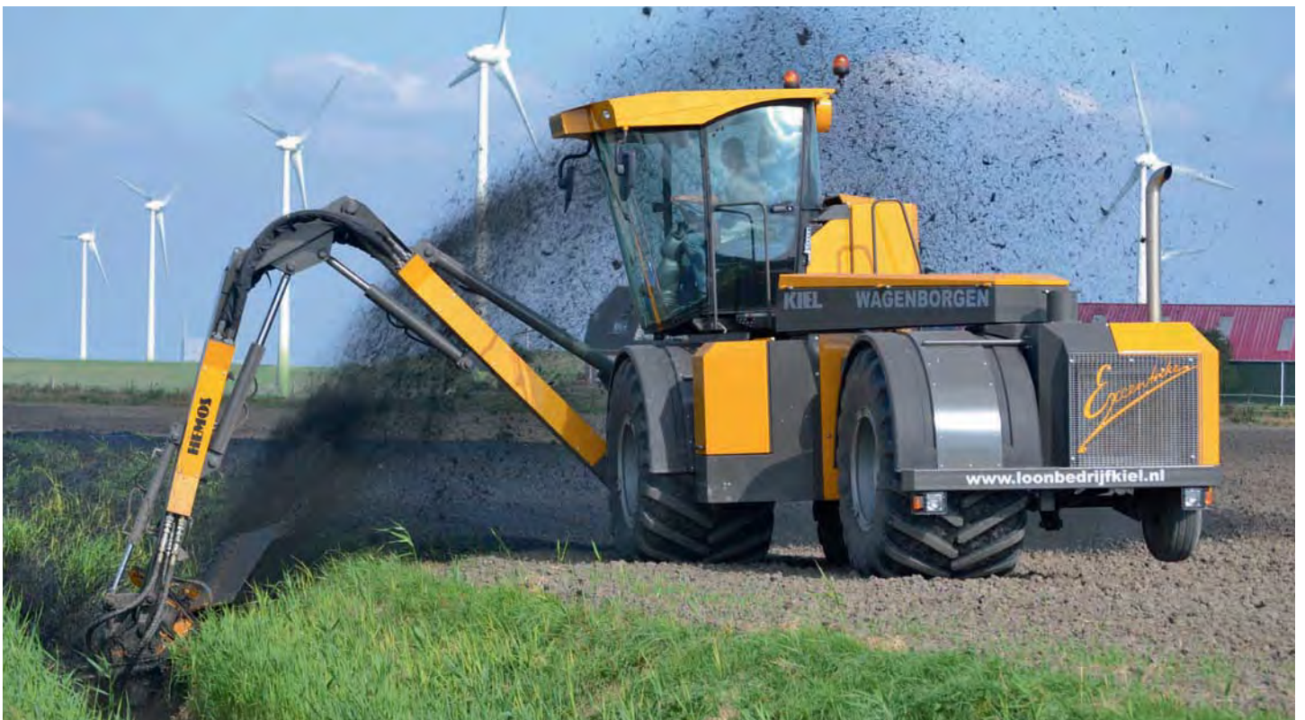
De Hemos Excentrike met slootreiniger.
