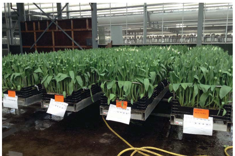
De proefopstelling was gebouwd rond bakken op een rail over de lampen worden geleid
