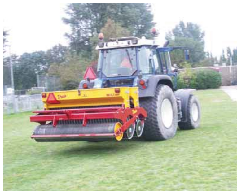
De Vredo Sport DDS werkt helemaal mechanisch. Eén loopwiel zorgt voor de aandrijving van twee versnellingsbakken die elk afzonderlijk de dosering van het zaaigoed aansturen.
