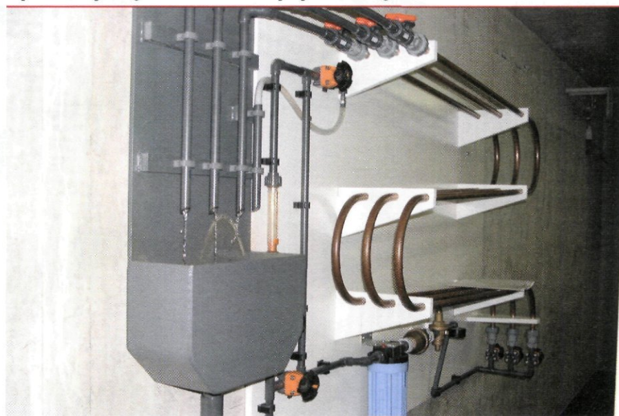
Koperen buizenopstelling voor het meten van het koperoplossend vermogen van drinkwater.
