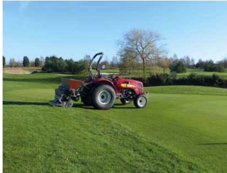
Naast nat zand kan de Topchanger ook mestsoorten, zeolieten en andere bodemverbeterende middelen aan de green toevoegen, de waterafvoer verbeteren en het organischestofgehalte van de bodem veranderen.
