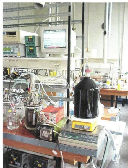
Laboratoriumopstelling van SHARON bij TU Delft.
