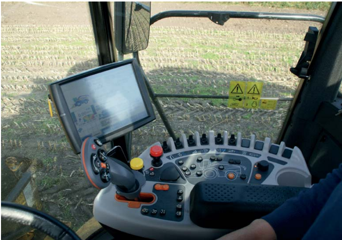
Het interieur is vernieuwd, evenals de zijconsole. Ook de bediening is op punten gewijzigd, zoals het omwisselen van het in- en uitschakelen van de kooi.
