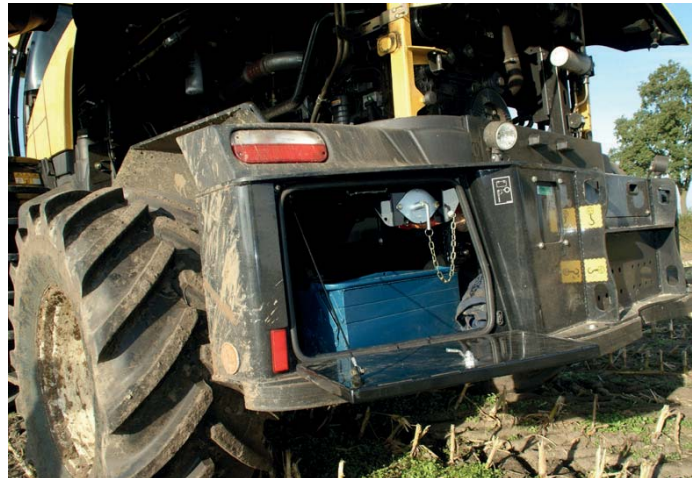
Het hakselaggregaat is niet gewijzigd. Wel zijn detailverbeteringen doorgevoerd, zoals meer ruimte tussen motor en uitlaat en deze nieuwe achterpartij.
