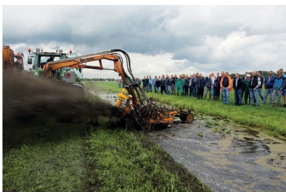
Loonbedrijf Verhoef uit Lopik heeft een Hemos-slootreiniger zodanig verbouwd dat al het vuil direct worden vermalen en op de kant wordt verspreid.
