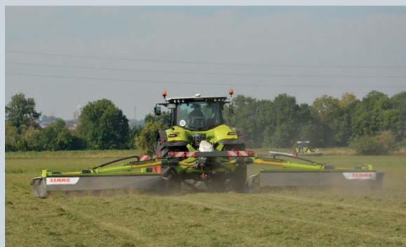
De Disco-vlindermaaier met een werkbreedte van maximaal 10,70 meter
