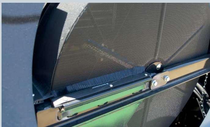
Een belangrijke vernieuwing is het zelfreinigende luchtfilter
