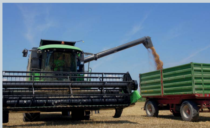
Bij het lossen is er een capaciteit van 75 liter per minuut.
