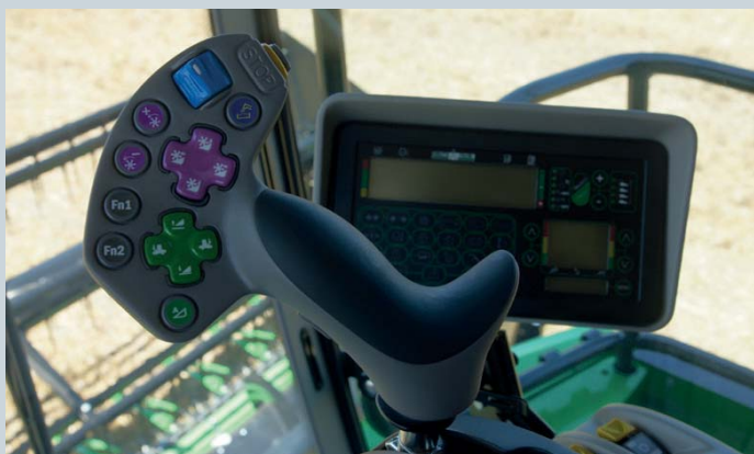
De nieuwe bedieningshendel op de C6000 combineert alle belangrijke functies. Ook zijn er twee vrije functies.
