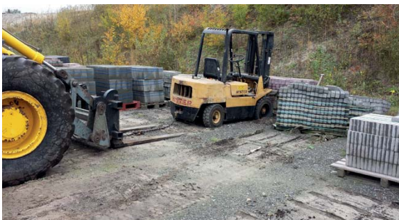
Werk altijd op een verharde ondergrond..
