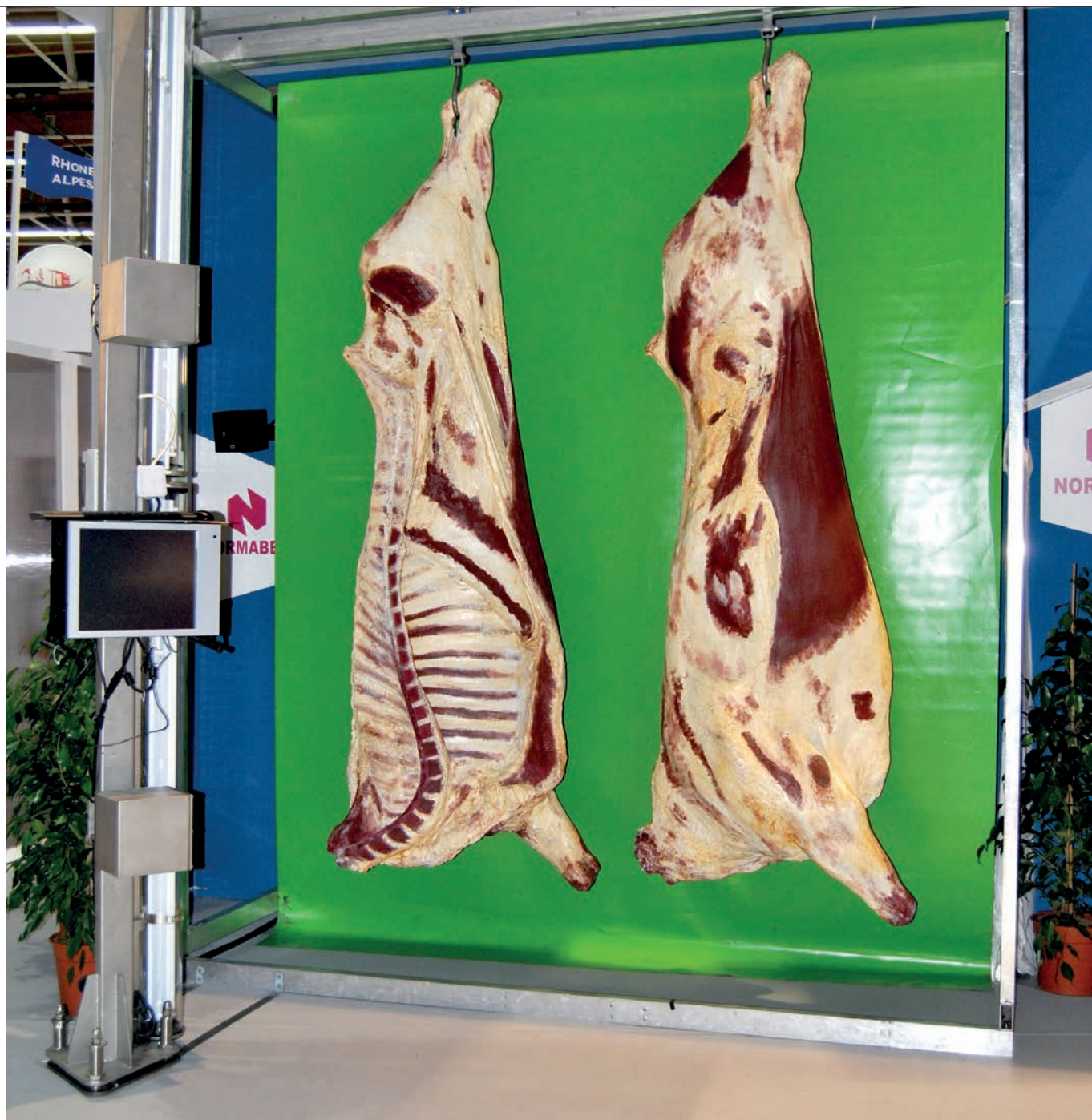
Het classificatietoestel vierde generatie kan tot 120 karkassen per uur een SEUROP-waardering geven
