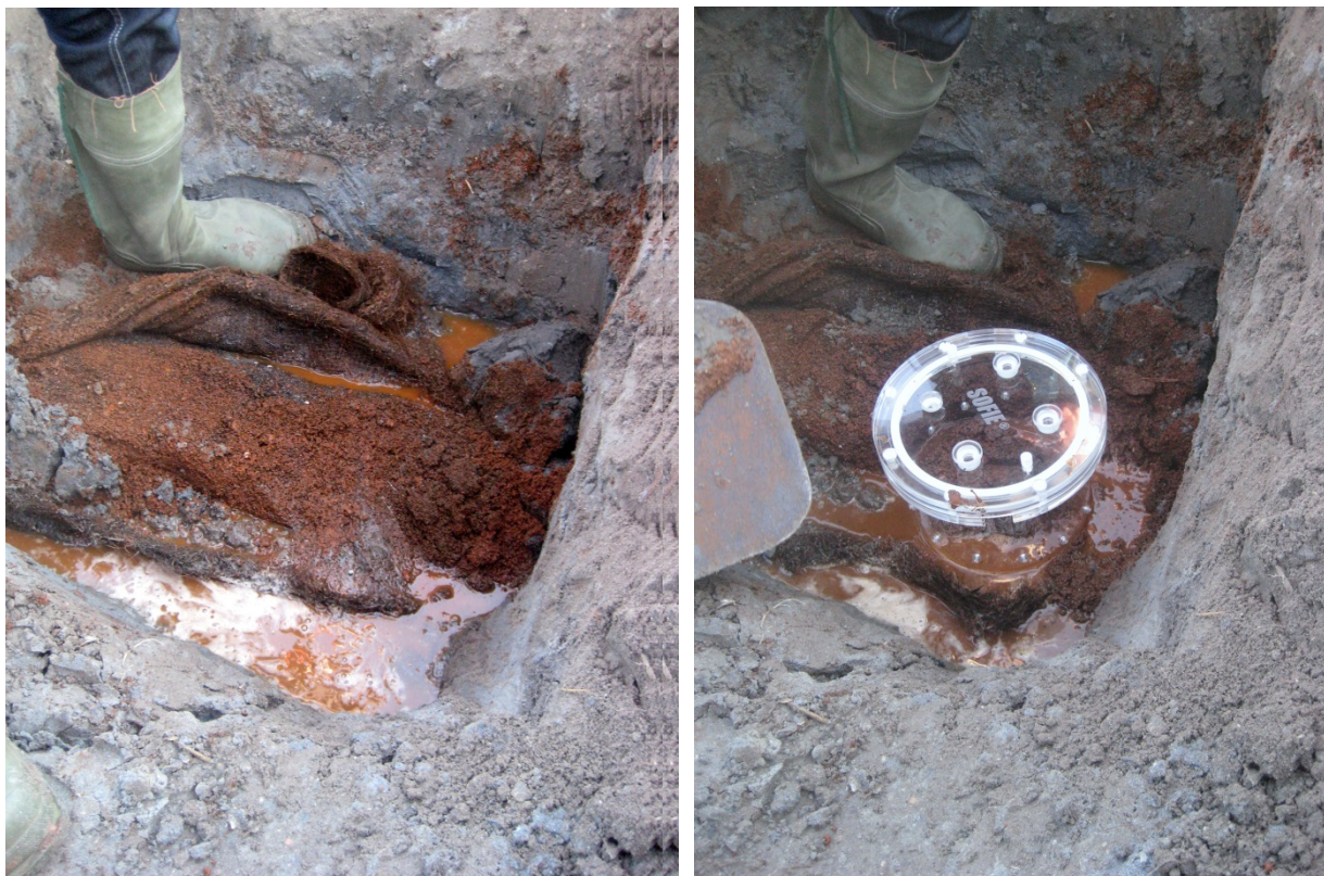
Figuur 5.1 Bemonstering van de omhulling van de P-bindende drain op t3 en in situ bemonstering van het omhullingsmateriaal met de Sofie-cel.
