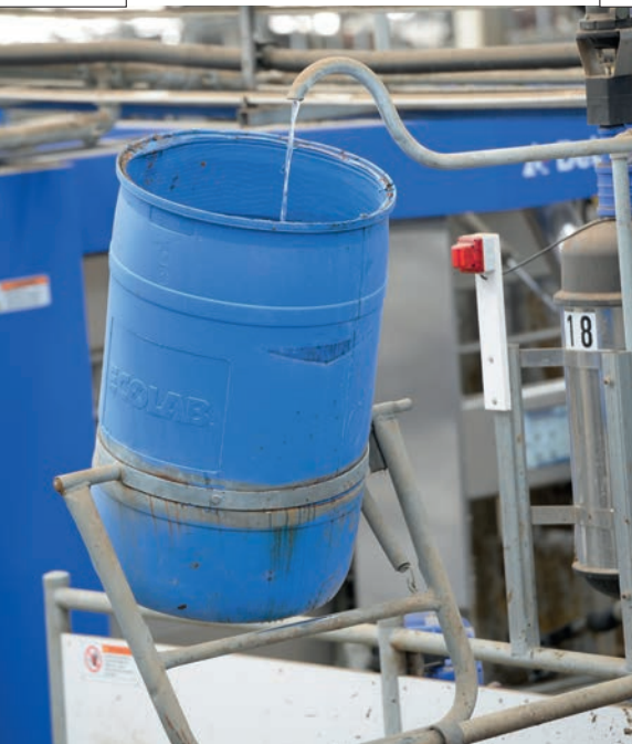
Het spoelwater van de robot wordt opgevangen en benut om de separatuurimte achter de robots nat te houden
