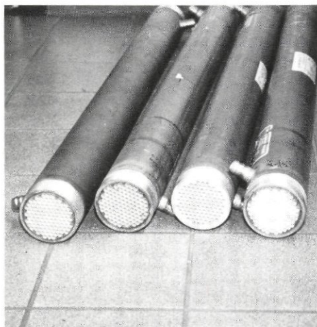
Afb. 1 - Gebruikte membraanmodules voor behandeling van spoelwater van zuiveringsstation Aalsterweg (NRE).
