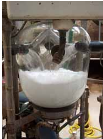
Foto 2 Reiniging van luchtafscieder; turbulentie en effect zijn visueel goed te beoordelen
