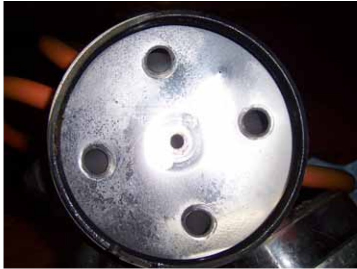
Foto 5 Voorbeeld van eiwitaanslag in de melkklauw
