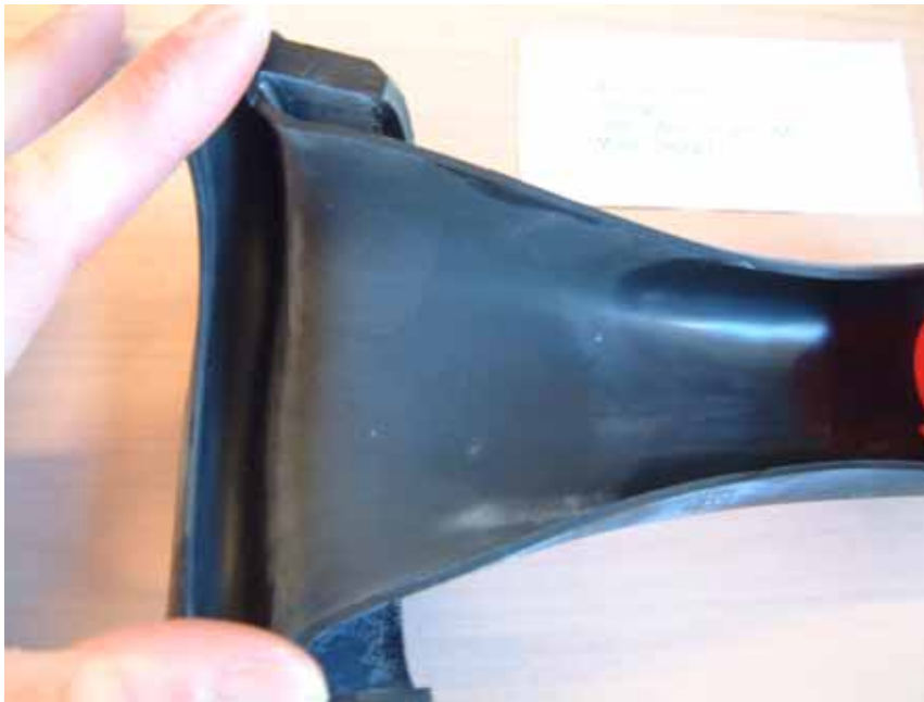
Foto 6 Beoordeling binnenkant tepelvoering na opensnijden. Deze voering heeft een patroon en is dof, maar er is geen witte aanslag te zien.
