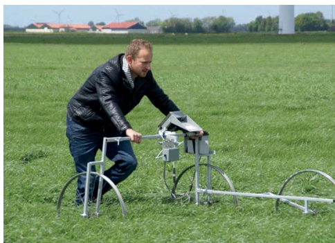
Wageningen UR is met een testapparaat bezig ijklijnen te ontwikkelen voor de pasture reader.
