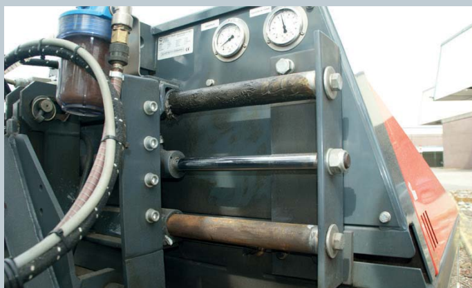
Standaard heeft de één meter breed werkende Weedsteam een veertig centimeter sideshift. Het enkele waterfilter is afdoende voor wie schoon kraanwater tankt.
