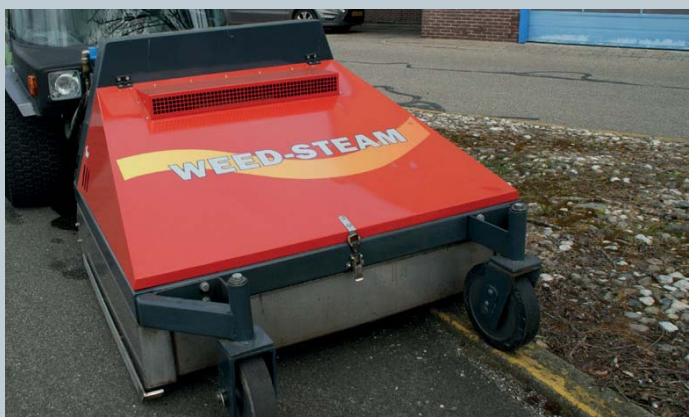
De Weedsteam heeft voor twee zwenkwielletjes en achter een stalen looprol die even breed is als de machine zelf. Met behoud van werking kan gerust een stoeprand worden gepakt.
