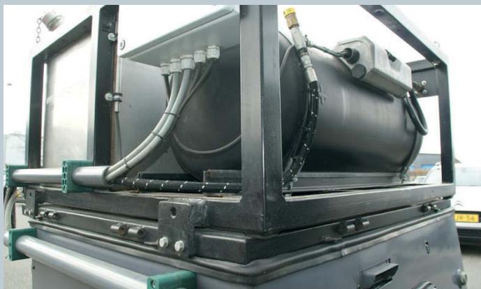
Beperkt gewicht achterop. Een enkele 85-liter-gasfles en een 200-liter-watervat zijn toereikend voor een dag werken.
