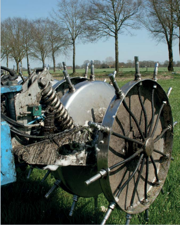
De elementen zijn nu paarsgewijs scharnierend opgehangen met veerdrukregeling.
