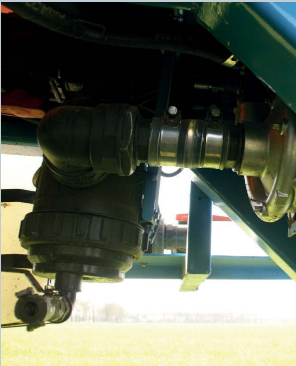
De membraanpomp is vervangen door een hydraulisch aangedreven centrifugaalpomp.
