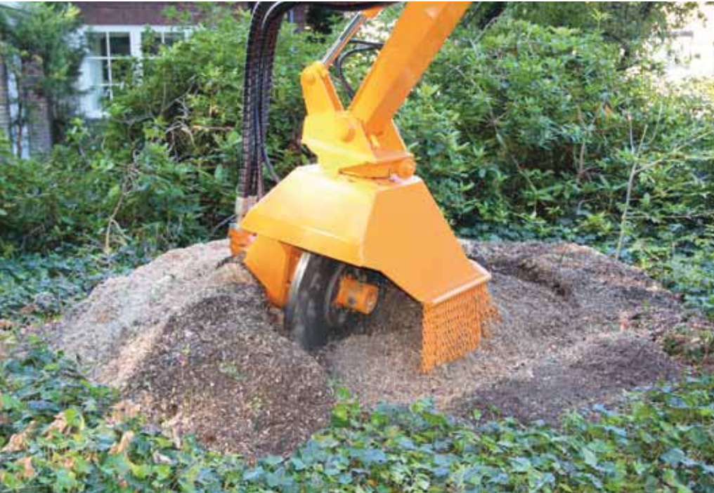
De stobbenfreeskop kan aan beide kanten 180 graden draaien.
