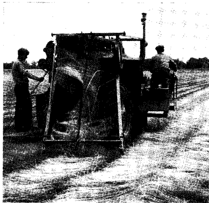
2. Opraap-ropelmachine (het geroepelde vlas wordt weer in dauwroot geleg voor voortzetting van het dauwrootproces)
