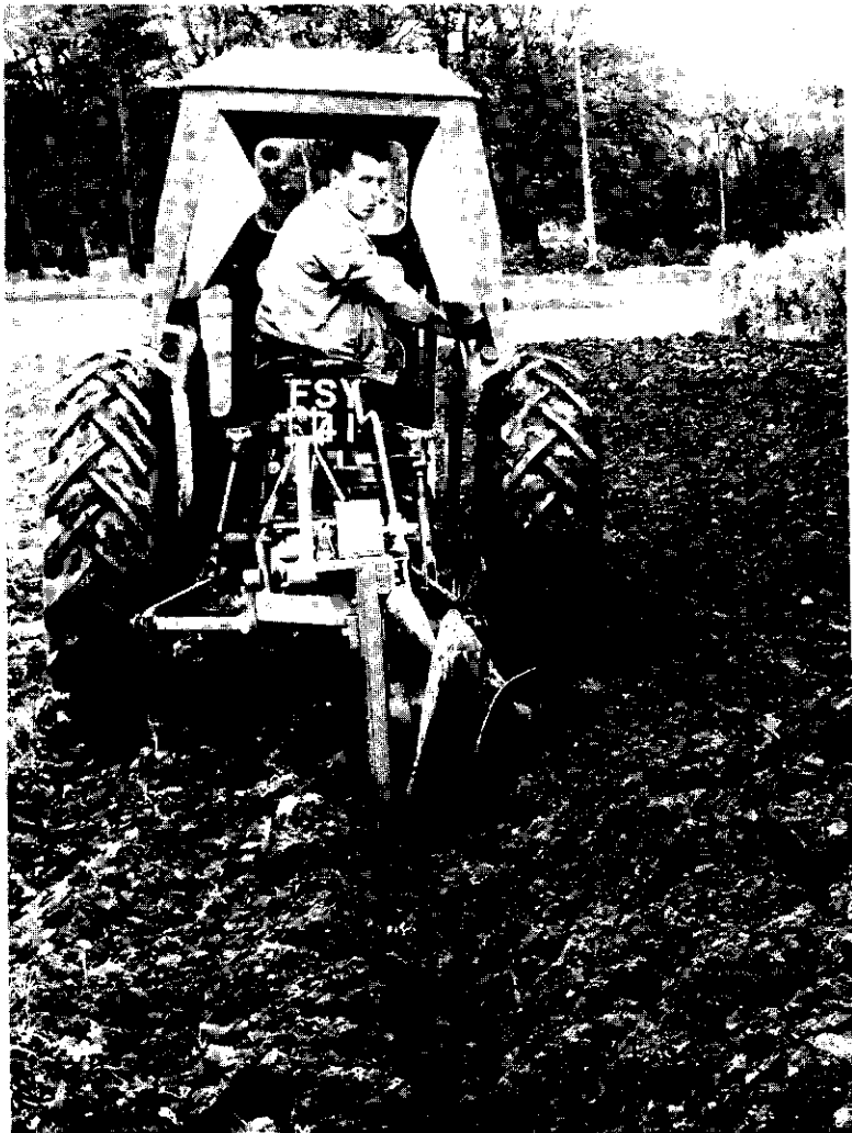
'Rotary plough', aangedreven door de aftakas van de trekker
