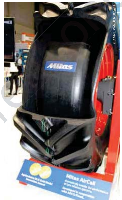
Fendt ontving op Agritechnica een gouden medaille voor het geïntegreerde bandendrukwisselsysteem VarioGrip Pro. De AirCell van Mitas maakt het mogelijk om binnen een halve minuut een drukverschil van 1 bar te realiseren.
