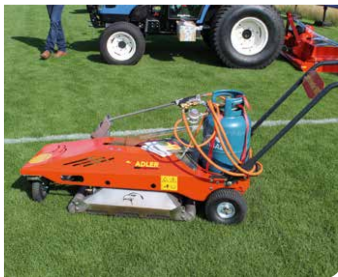
De capaciteit van de ADLER Infraheater 500 bedraagt dan tussen 1000 en 2000 m 2 per uur
