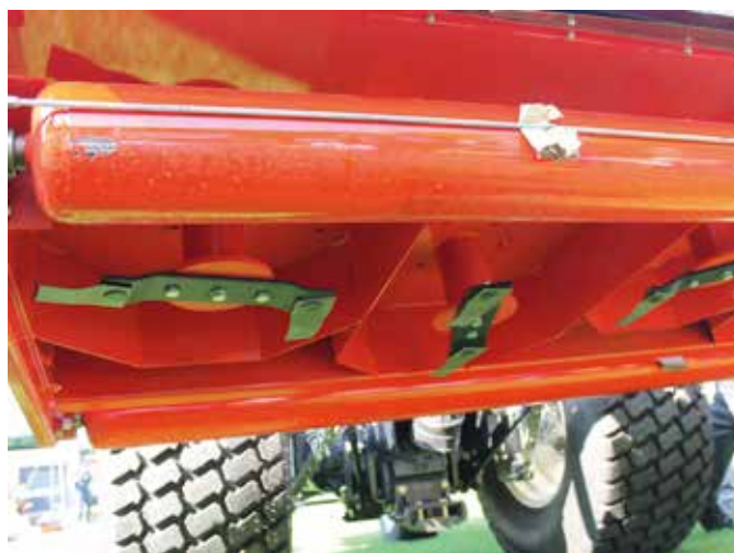
De TRIMAX maaiers onderscheiden zich omdat ze een rol voor en achter op de machine hebben. De snijhoogte kan traploos afgesteld worden van 10 tot 100 mm
