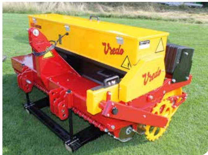
De VREDO 218.03.05 supercompact kan fijn graszaad zeer nauwkeurig in de zode doseren
