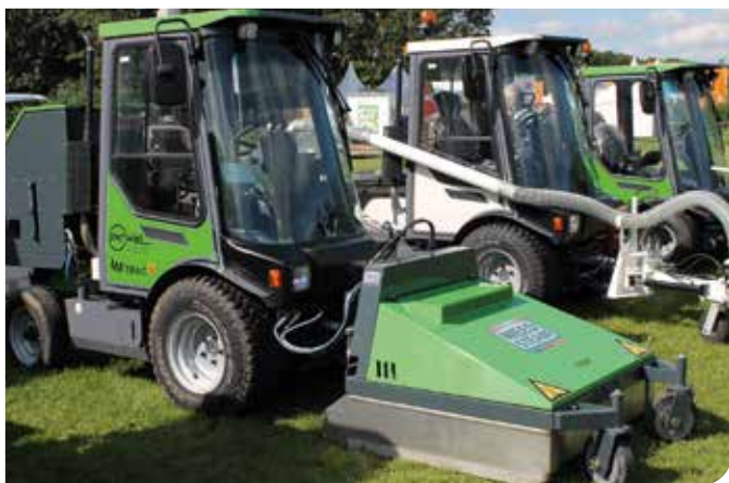
De WeedSteam bestaat uit een hete lucht/infrarood/stoomunit aan de voorzijde
