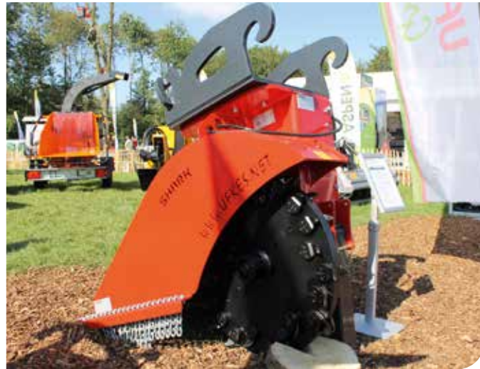
De Shark 8 stobbfrees geschikt voor hydraulische kranen van 13 tot 25 ton
