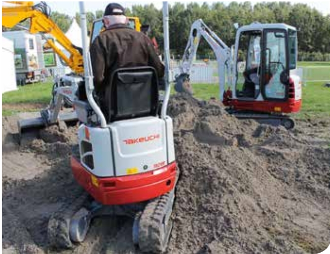
De nieuwe TB210R graafmachine kan met een breedte van 75 cm door de voordeur
