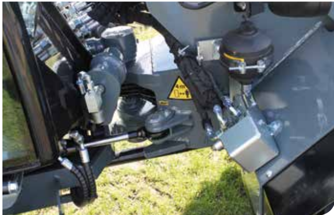
Twee cilinders, gemonteerd in het knikpunt, beschermen tegen kantelen
