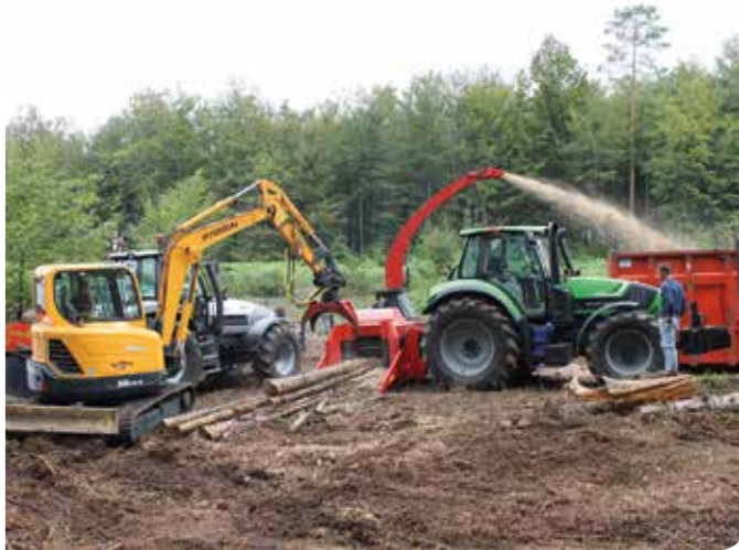
Drumversnipperaars kenmerken zich door een brede invoer waardoor zijtakken en splittings gemakkelijk door kunnen
