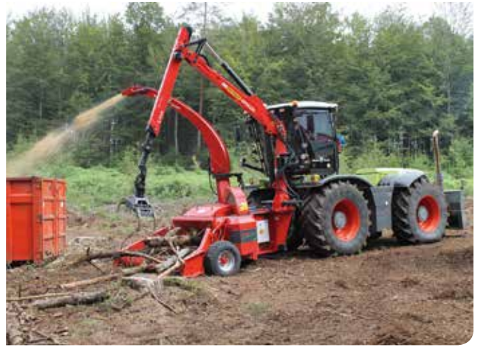
Door de snijhoek van 50° draait de machine zeer licht en is hij zuinig met brandstof
