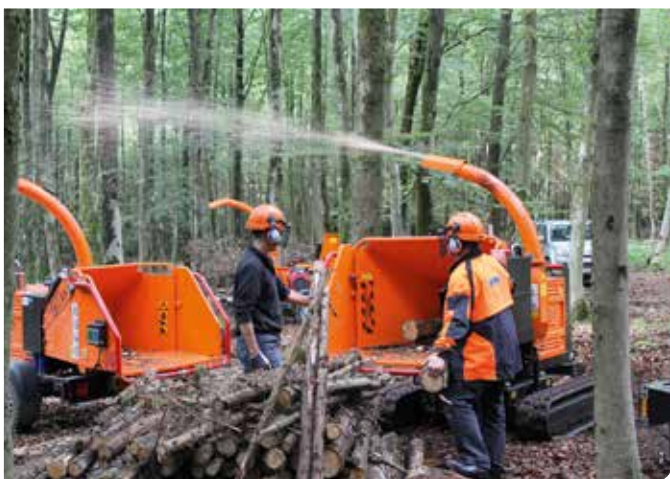
Deze versnipperaar is breed inzetbaar kan deze zelfs over boomstronken heenrijden
