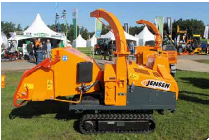
Deze machine is zeer compact en door zijn rupsonderstel bijzonder wendbaar
