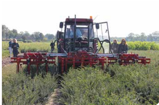
▲ Boomkwekerij Dictus-Herreijgers: De wiedzmachine bewerkt 3 teeltbedden in één handeling.
