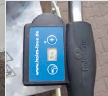
Met de afstandsbediening op de doseerarm kun je tussen de verschillende doseerprogramma's schakelen.
