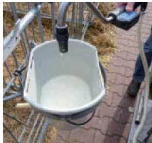
De doseerarm geeft exact de vooraf ingestelde hoeveelheid af en is te bedienen terwijl de gebruiker achter de machine loopt.
