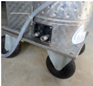
Koppelingen voor de watertoe- en -afvoer voor het koelproces tijdens de pasteurisatie van de melk zitten aan de zijkant van de machine.
