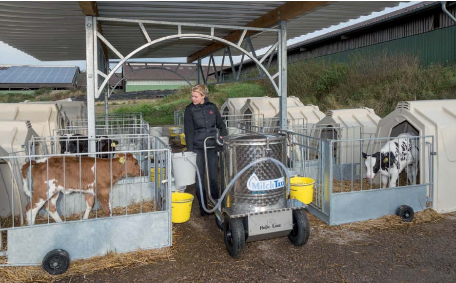
De inhoud wordt elektrisch verhit, zodat de melk op exact de juiste temperatuur aan de kalveren kan worden gegeven.
