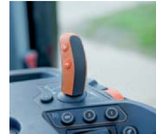
Een tik tegen het pientere pookje naar voren of achteren is één stap omhoog of omlaag. Een tik naar rechts en de bak schakelt automatisch.
