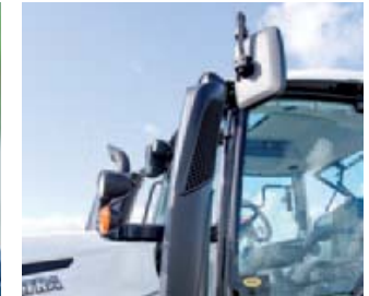
De luchtinlaat en de uitlaat staan los van de cabine en zijn afgeplat in de kijkrichting. Ze hinderen het zicht nauwelijks.
