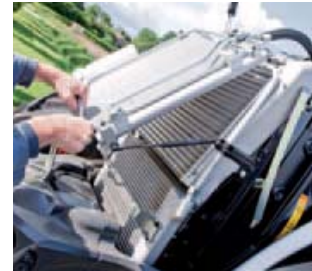
De koelers zijn gemakkelijk uit te klappen en dus makkelijk te reinigen. Ook de verschillende filters en vulopeningen zijn goed bereikbaar.
