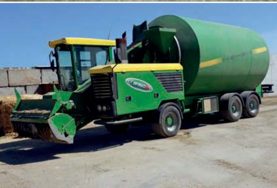
De voermengwagen met het mengprincipe van een betonmolen vermoest nooit
