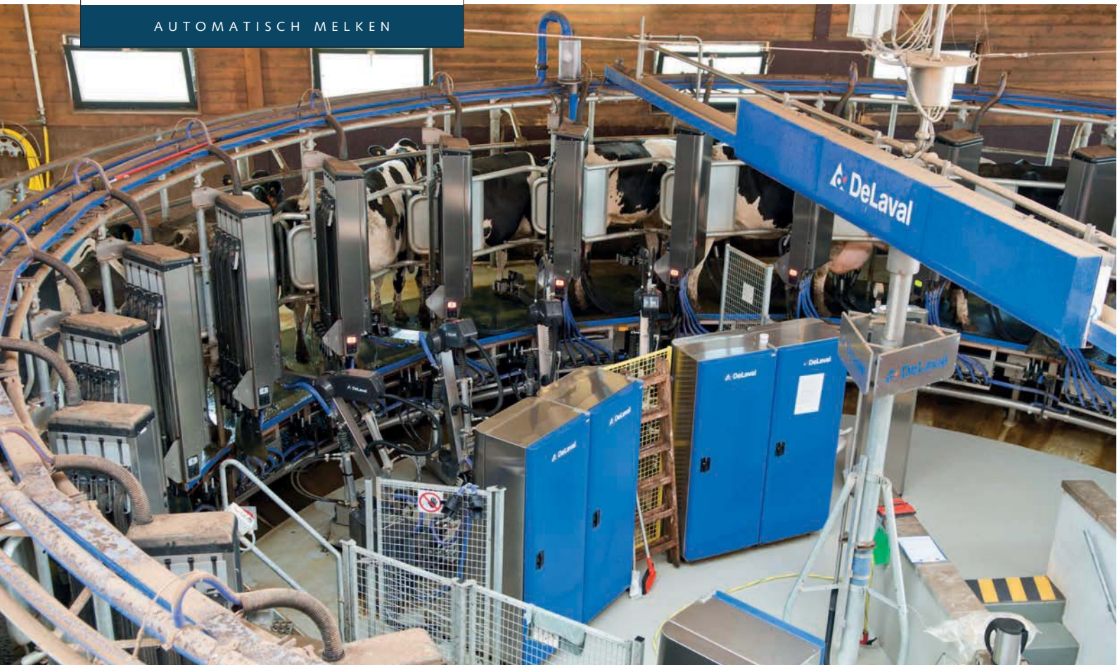
Een recente ontwikkeling zijn draaimelkstallen met een automatisch aansluitsysteem
