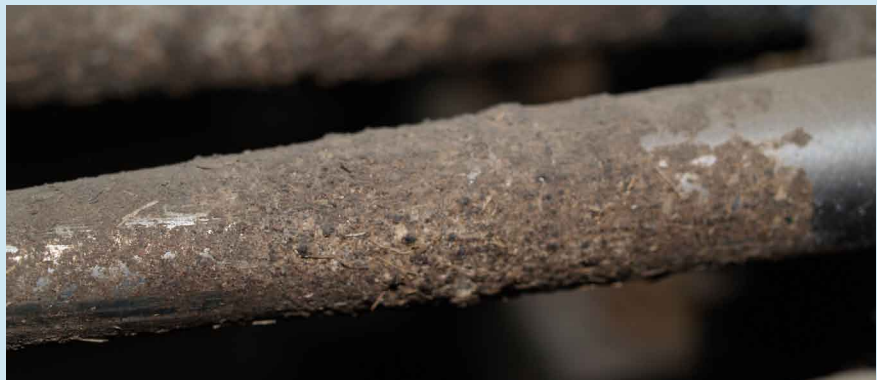
(Foto 2) Vervuilde rollen leiden tot beschadiging van de bollen.
