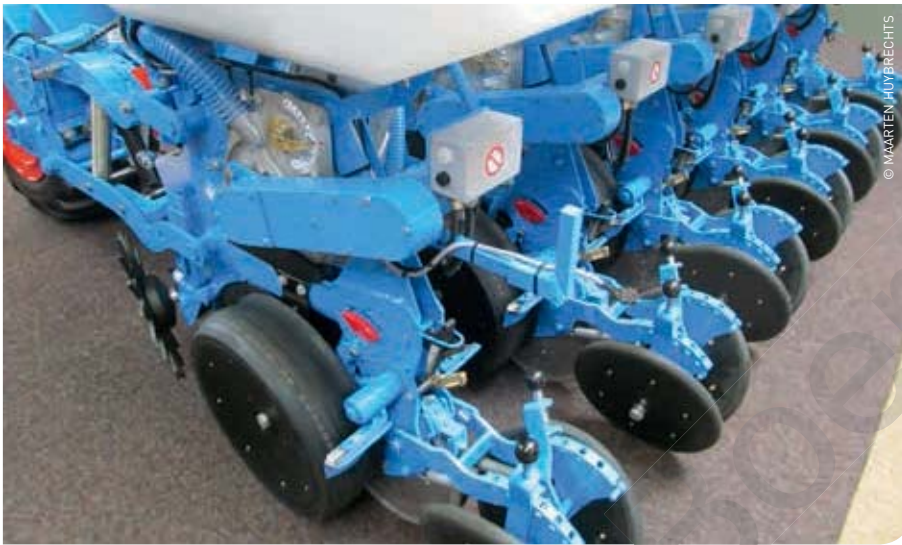
Bij de elektrische aangedreven zaaielementen plaatst Monosem de elektromotor op veilige hoogte zodat deze ook gemakkelijk toegankelijk is. De verdere overbrenging gebeurt met een getande riem.
