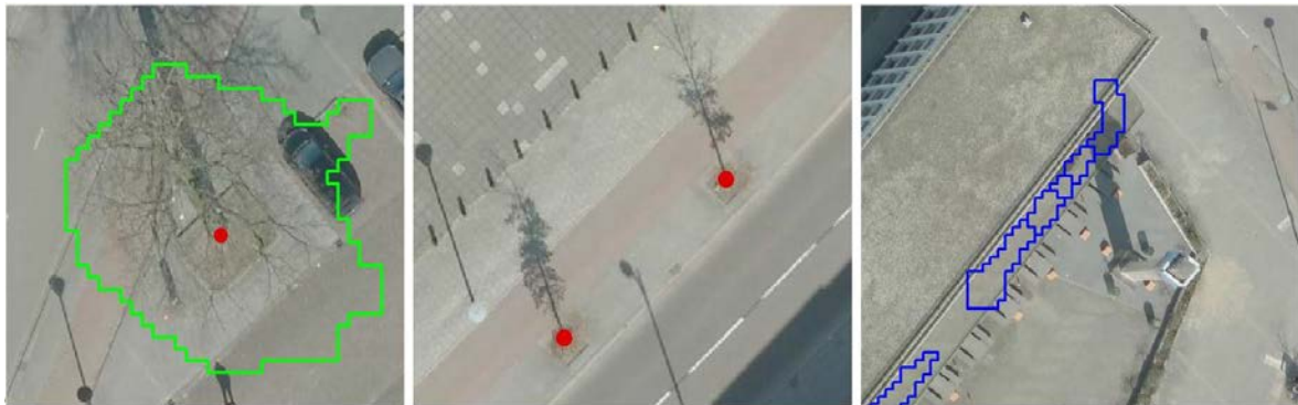
Figuur 3.10 Op de linkerfoto wordt een werkelijk positieve kroonprojectie weergegeven (de rode punt representeert de veldmeting); op de middelste foto twee fout negatieve situaties en op de rechterfoto een fout positieve kroonprojectie (weergegeven in blauw).
