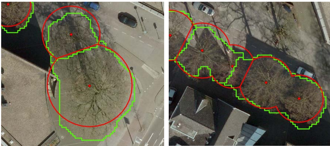
Figuur 3.11 Op de linkerfoto wordt de geëxtraheerde boomkroonprojectie (groen) vergeleken met de referentiedata (rood); op de rechterfoto wordt dezelfde vergelijking getoond, alleen dan voor meerdere bomen.
