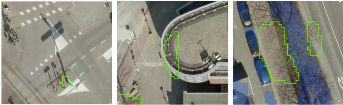
Figuur 5.3 Fout positieven: op de linker afbeelding wordt een verkeersbord getoond (groene belijning) die als boom is geclassificeerd, op de middelste afbeelding de rand van een gebouw. Op de rechter afbeelding wordt een door nodata-cellen (in blauw aangegeven) gesplitste boomkroon getoond.
