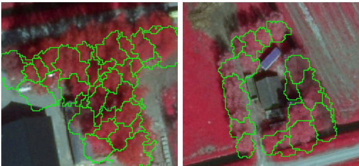
Figuur 3.13 Op beide beelden wordt in het groen de boomkroonprojectie getoond die gebaseerd is op AHN2-rasterdata. Op basis van het getoonde beeldmateriaal is het nagenoeg onmogelijk om de individuele bomen te detecteren.
