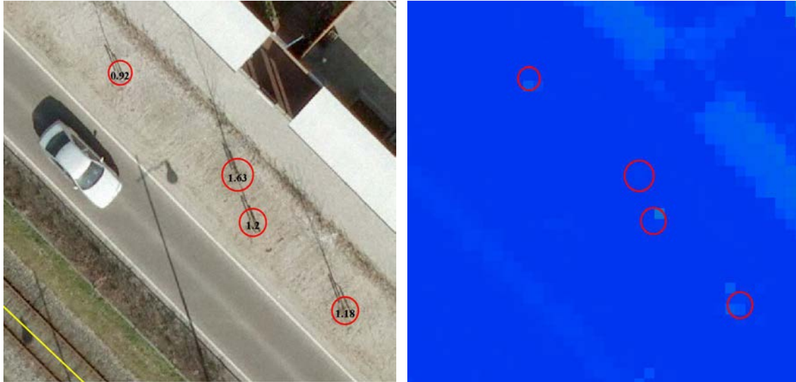
Figuur 5.2 Op de linker luchtfoto worden 4 foute negatieve boomkronen en hun bijbehorende oppervlakte (in m^2 ) getoond. Op de rechterfiguur worden dezelfde bomen getoond, alleen dan met AHN2-DSM als achtergrond.
