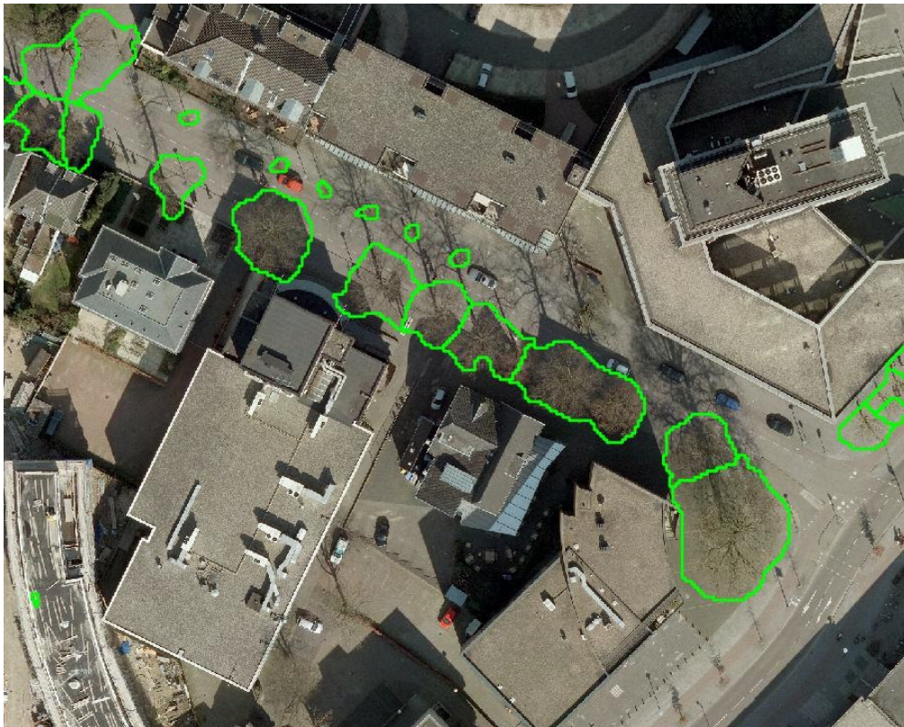
Figuur 2.2 Voorbeeld van het resultaat van de boomkroonextractie. De boomkroon is weergegeven in groen.
