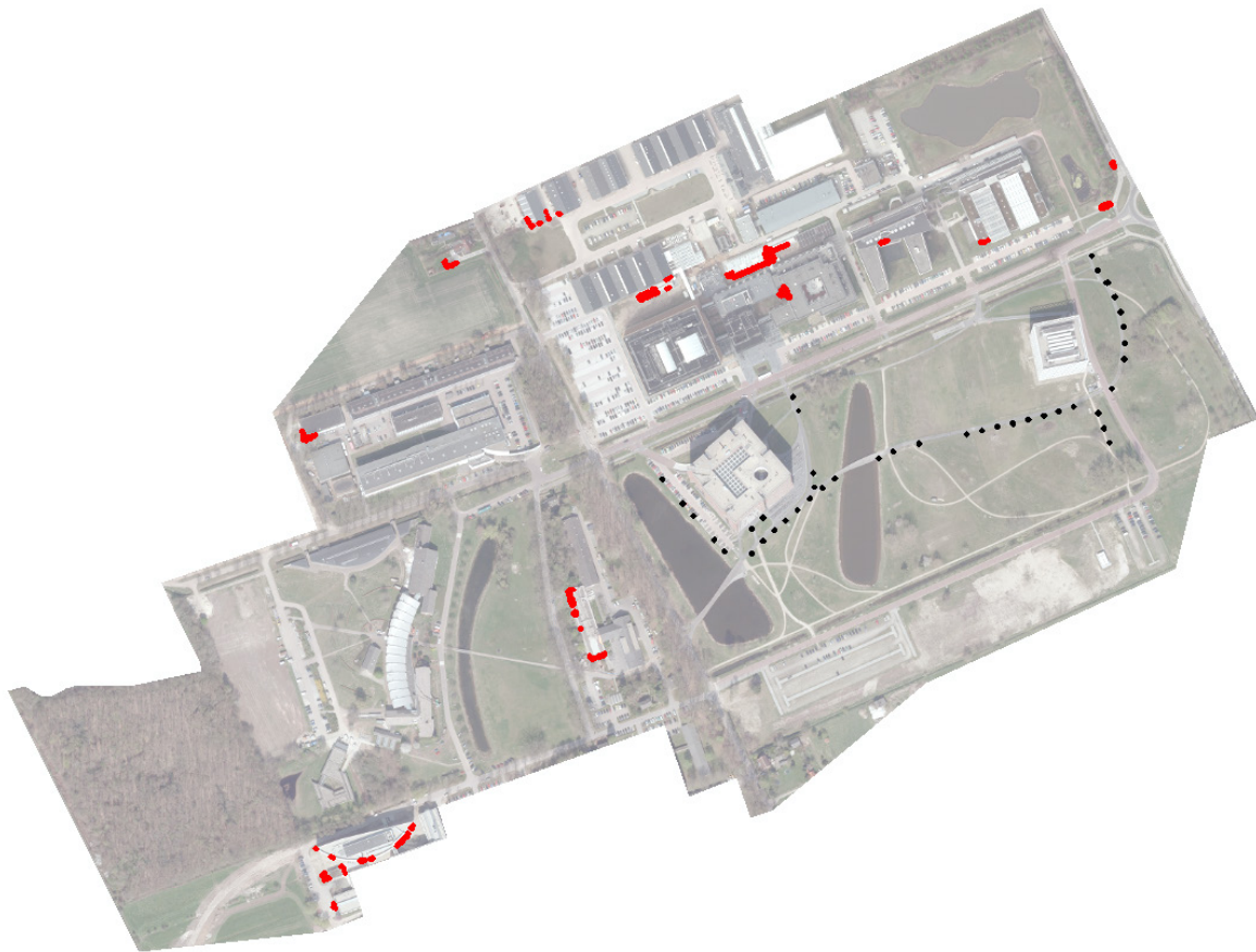
Figuur 4.8 Een voorbeeld van Fout-positieve objecten, gegenereerd door BEM 9.2 ten opzichte van het SVO-model. In zwart vermoedelijk lantaarnpalen, in rood dak- en wandeffecten van gebouwen.
