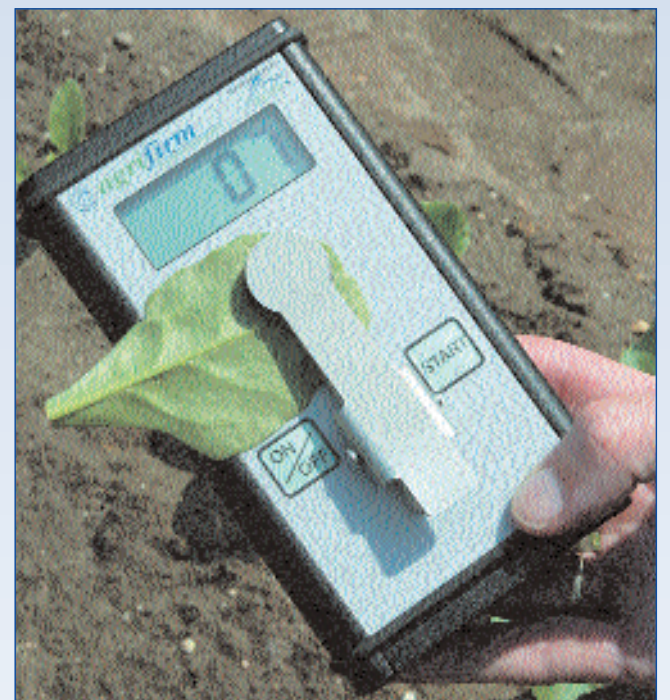
Met dit draagbare meetapparaat kan kort na de bespuiting via fotosynthesemeting worden vastgesteld in hoeverre de bespuiting effectief is geweest.
