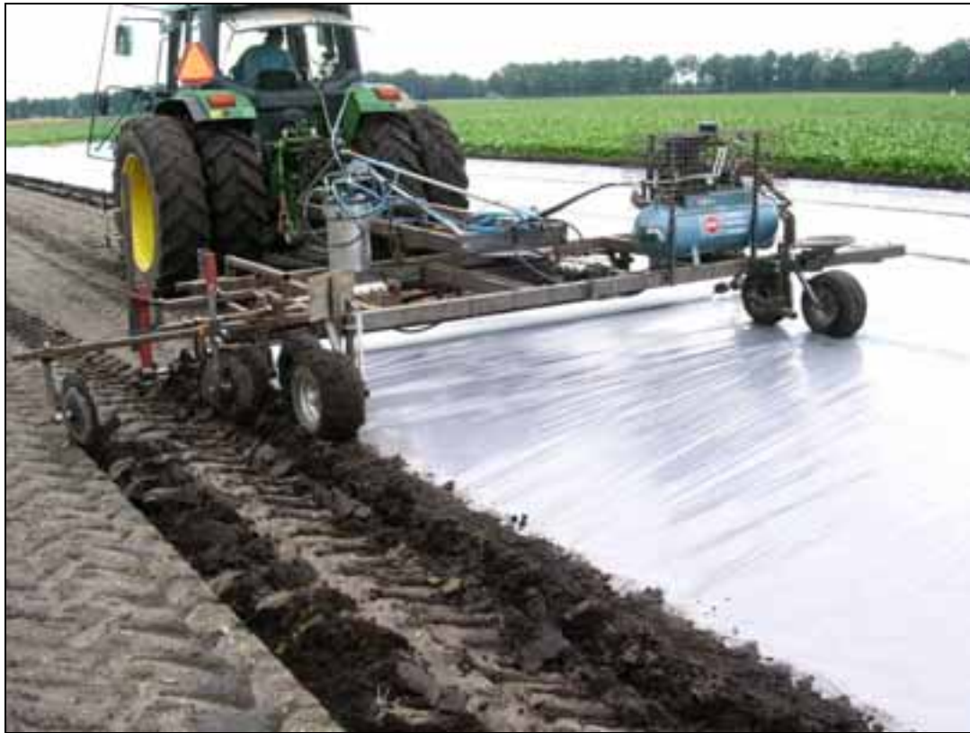
Foto 1 Folielegger lijmt foliebanen aan elkaar
