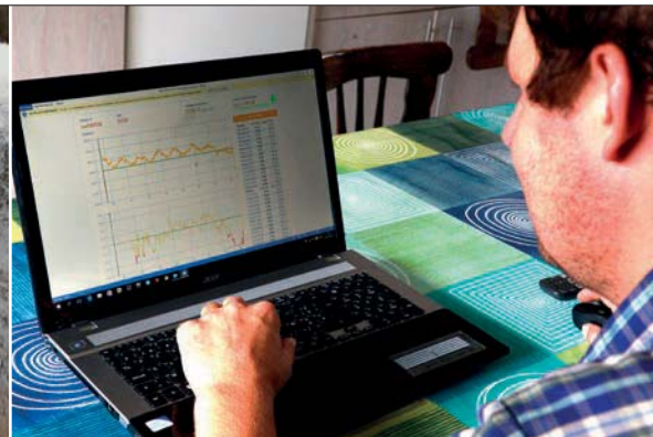
Met behulp van een sensor met temperatuurmeting wordt het ideale kalftijdspit voorspeld
