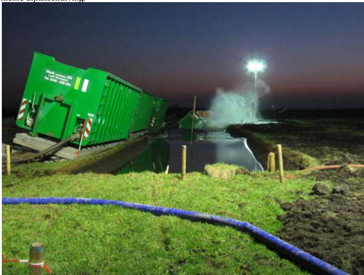
Afbeelding 2. Veldproef: een veenpakket wordt steeds zwaarder belast, totdat het bezwijkt...
