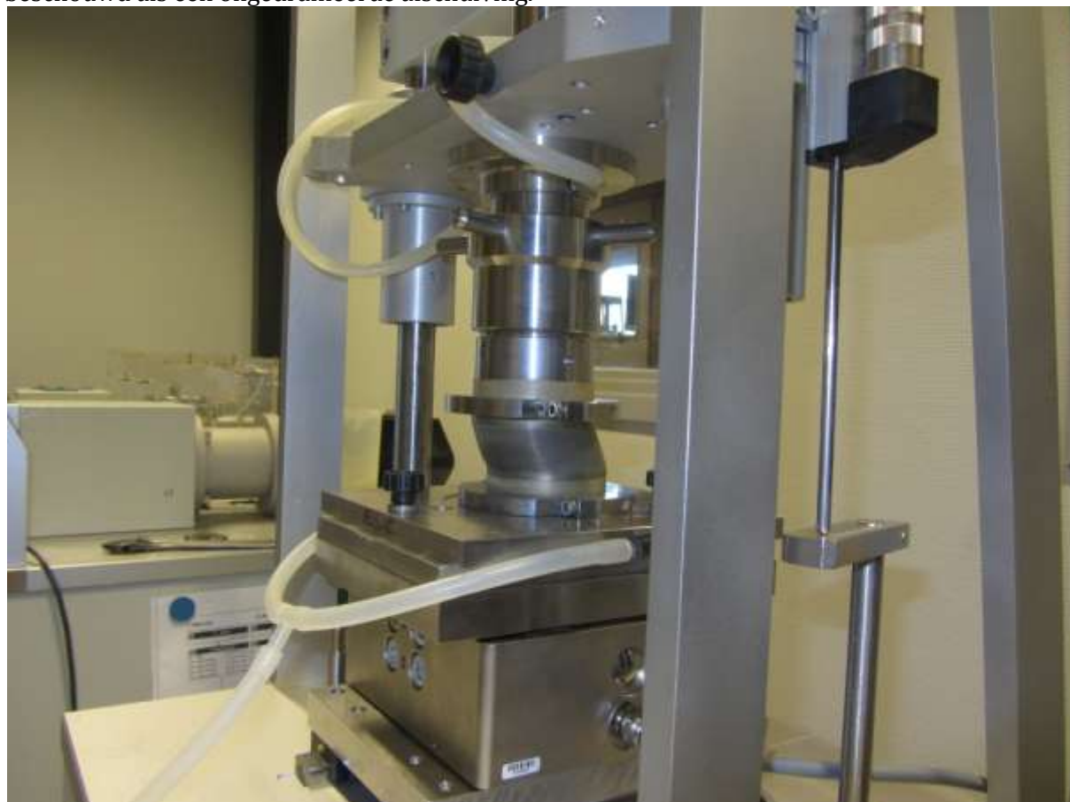
Afbeelding 3. DSS-proef, een onderdeel van het bepalen van de sterkte en het gedrag van het veen in de nieuwe ontwerpmethod
