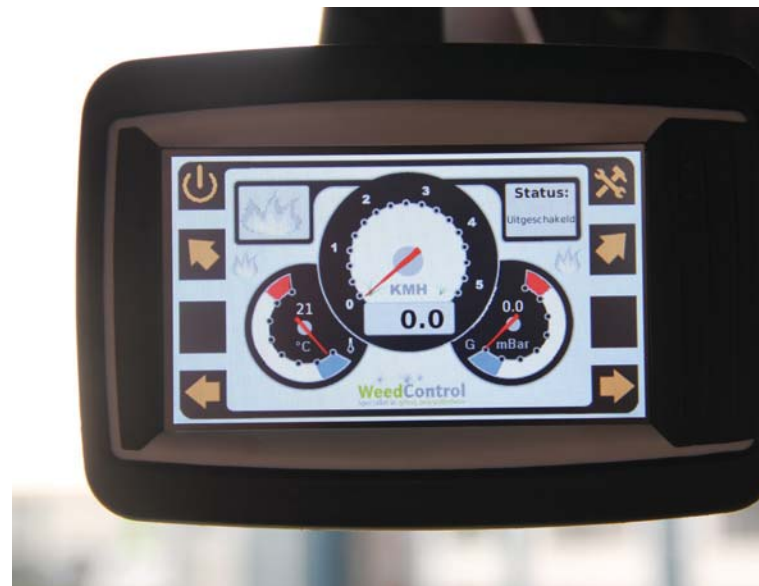
Een PLC met touchscreen met veel bedieningsgemak.
