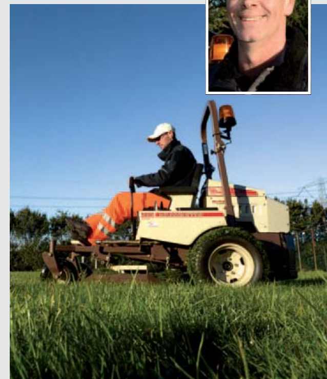
De Grasshopper-maaiër van het Molecaten park Kruiniger Gors is voorzien van een extra mulchmes in de maaiërbalk die het gras extra klein slaat.
