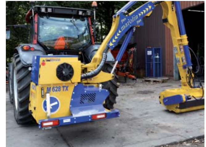
Met een maaiarm kun je werkzaamheden op een paar meter naast de trekker uitvoeren. Maar let op, een maaiarm zorgt wel voor zware dwarskrachten op de trekker.
