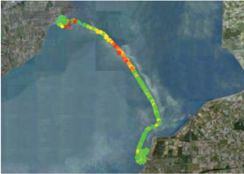
Afbeelding 4. Deformatie van de Houtribdijk gebaseerd op radarbeelden (bron : www.hansjebrinker.com )
