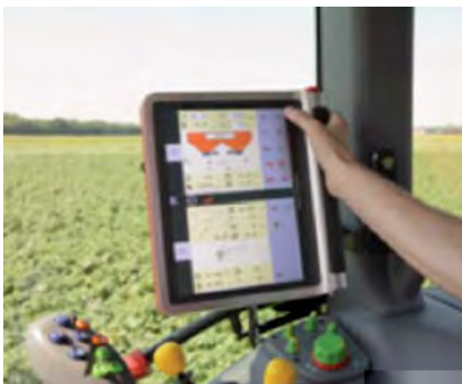
Afbeelding 1. Gebruik van boordcomputer en GPS voor 'recht rijden' op de akker
