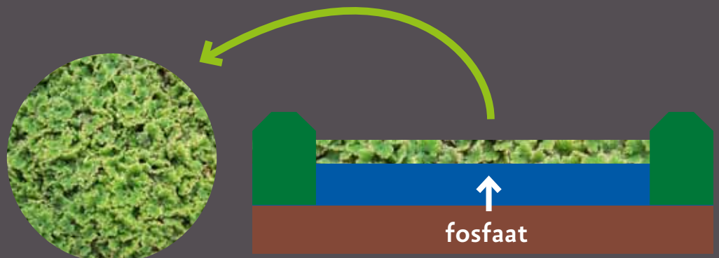
Figuur 3 Uitmijnen van fosfaatrijke bodem met behulp van Azolla . Azolla sluit de waterlaag af voor diffusie van zuurstof, waardoor behalve in de bodem ook zuurstof arme condities ontstaan in de waterlaag. Het fosfaat dat onder deze zuurstofarme condities wordt gemobiliseerd kan hierdoor bovenin de waterlaag worden opgenomen door Azolla . De Azolla kan vervolgens worden geoogst en vermarkt.
