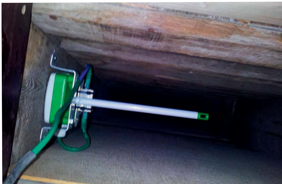
Tijdens de heetstook zijn in diverse rijen in verschillende kisten op verschillende lagen en ook op verschillende niveaus in dezelfde kist thermometers geplaatst
