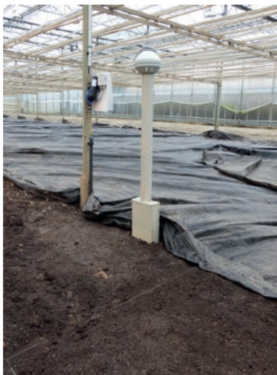
Figuur 2.2 Lysimeter voorzien van stoomafzuig ventilator, om ervoor te zorgen dat bij stomen een voldoende effect op diepte wordt bereikt.
