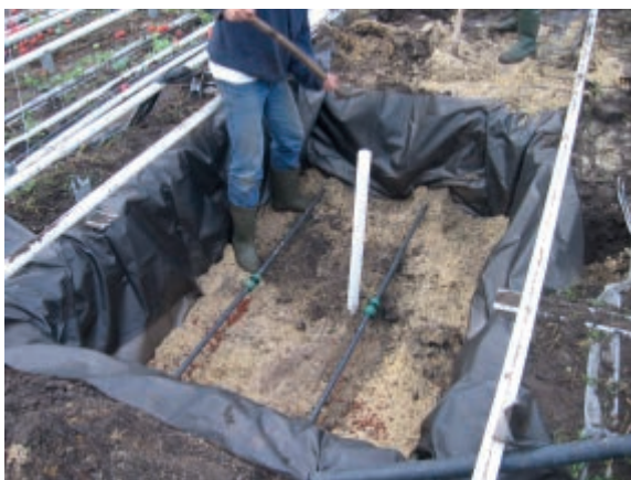
Figuur 1.1 Aanleg van het eerste prototype van de lysimeter; de zogenaamde foliebak.
