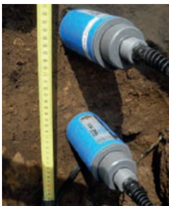
Figuur 2.5 Sensoren die rechtstreeks op de klimaatcomputer kan worden aangesloten: Imko (Eijkelkamp).
