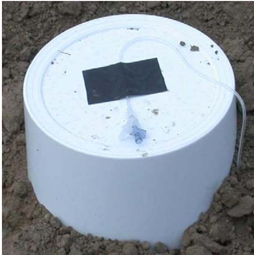
Figuur 4. Foto van een emmer die gebruikt is voor het opvangen van het gas. Het slangetje gaat in de emmer. Via het kraantje kunnen gasmonsters genomen worden.
