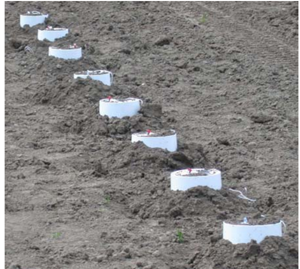
Figuur 5. Foto van een rij van fluxkamers. Rond de emmers is de bodem iets aangedrukt.
