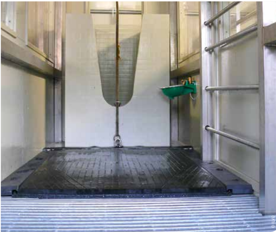
ILVO beschikt over 6 individuele gasuitwisselingskamers voor het meten van de \text{CH}_4 - en \text{CO}_2 -uitstoot.
