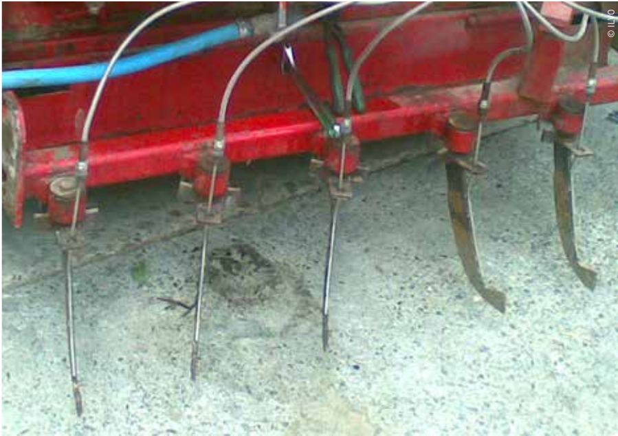
Injector met vrije uitloop beschermd door koutermes.
