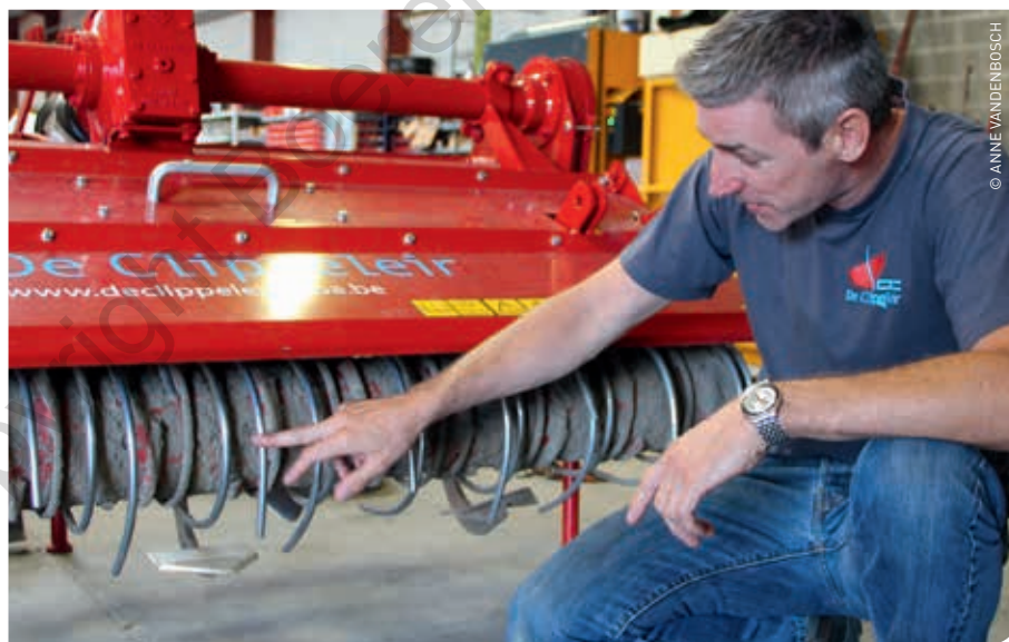
“Meestal wordt de spitmachine uitgerust met een verkruiemrol. De 2 ‘spiraal’ zorgen voor een mooie verkruiemeling van de toplaag en geven een egaal zaaibed”, toont Hans De Clippeleir. “Je ziet hier ook enkele spades op de achterliggende as.”
