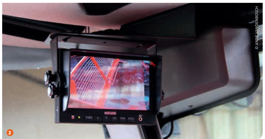
1 “De chauffeur heeft vanuit zijn cabine een optimaal zicht”, toont Robin Vervae. “Zo is de bunker kooi op de hoek afgeschuind, zijn er verschillende camera’s en grote spiegels.” 2 De operator kan via camerabeelden zowel de werkzaamheden als de veiligheid controleren. Hier een beeld van de camera opzij, waarmee het lossen van de bieten in de kieper kan gevolgd worden.
